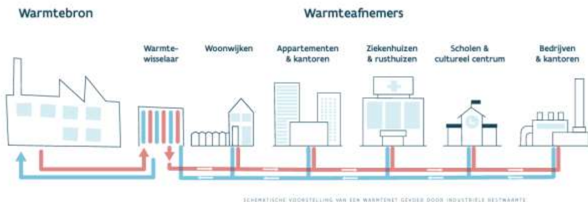
Figuur 4: Schematische voorstelling van een warmtenet met als warmtebron restwarmte uit industrie. In warmtenetten met aquathermie, zal aquathermie uit oppervlaktewater de warmtebron vormen i.p.v. restwarmte uit industrie (bron: Warmtegids VVSG i.o.v. VEKA)
